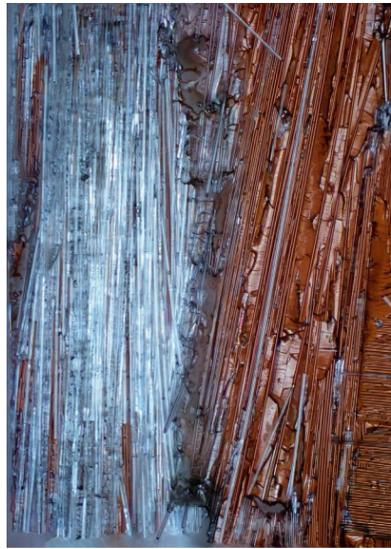
Heilung unter dem Mikroskop: Die Aufnahme zeigt, wie sich Beschädigungen einer Glasfaser (links) durch Polymerisation schließen (rechts).
