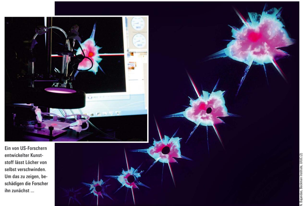
Ein von US-Forschern entwickelter Kunststoff lässt Löcher von selbst verschwinden. Um das zu zeigen, beschädigen die Forscher ihn zunächst ...
